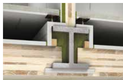
Projektové řešení: kapslování stropního detailu s dutinovou podlahou – CLT / ocelový nosník
