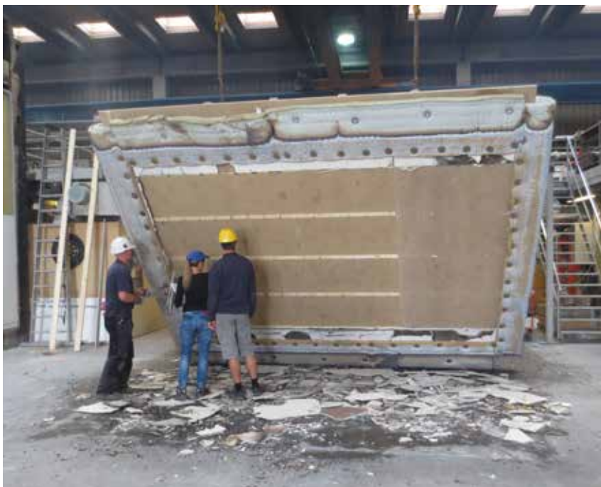
K 2 60 zkouška vzorku konstrukce – dvě vrstvy fermacell® – kontrola nosné desky
