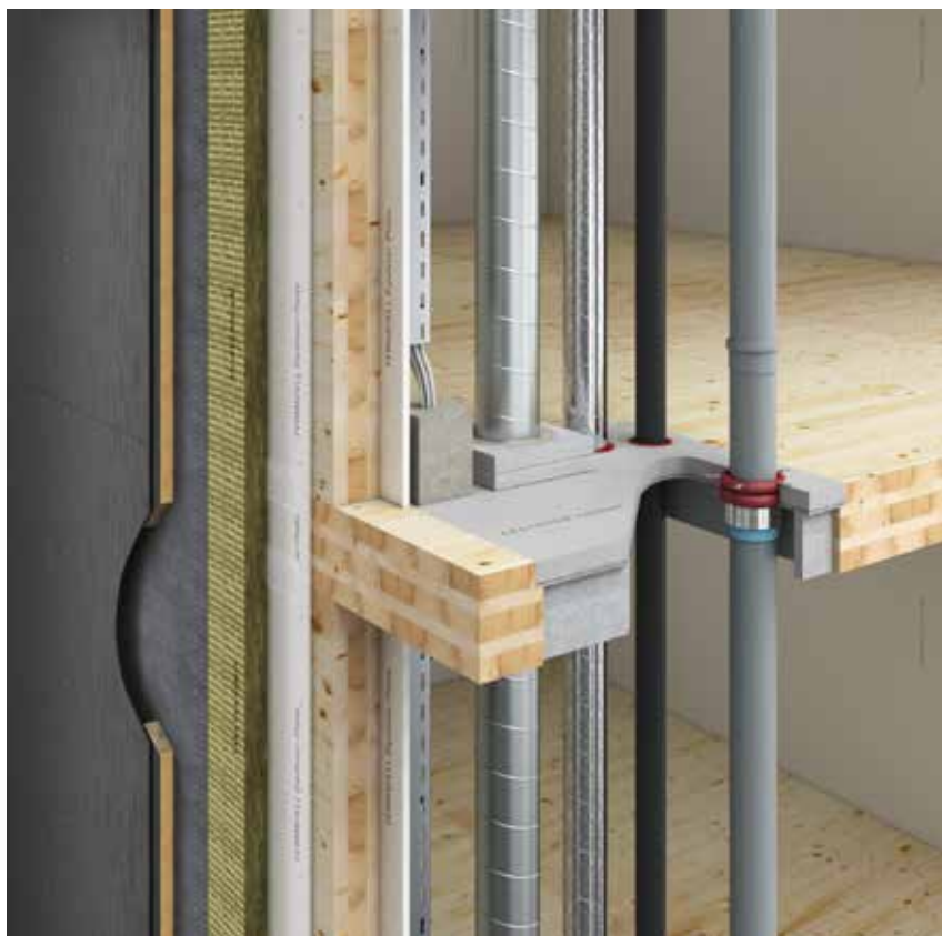
Aestuver™ FireShield – systémové řešení prostupu stropní konstrukcí z CLT panelů (projektové řešení)
