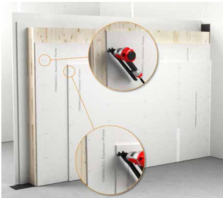
Upevnění deska do desky
