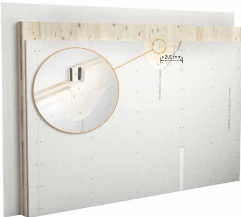
Spoj CLT panelů – stupňovitá drážka
