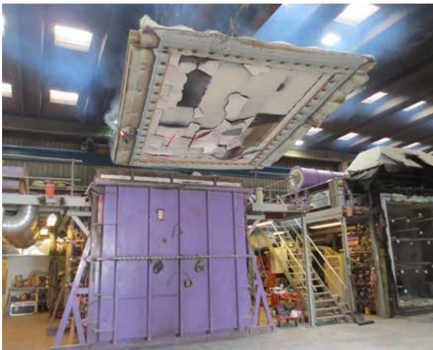
K 2 60 zkouška vzorku konstrukce – dvě vrstvy fermacell®
