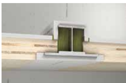
Projektové řešení: kapslování stropního detailu – CLT / ocelový nosník
