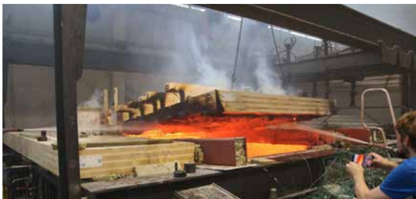
IGNIS – Požární zkouška stropu z CLT panelů /ocelového nosníku (IBS Linz)
