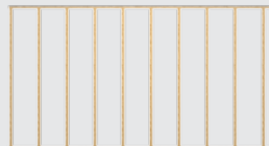
Osová vzdálenost spodní konstrukce max. 500 mm
