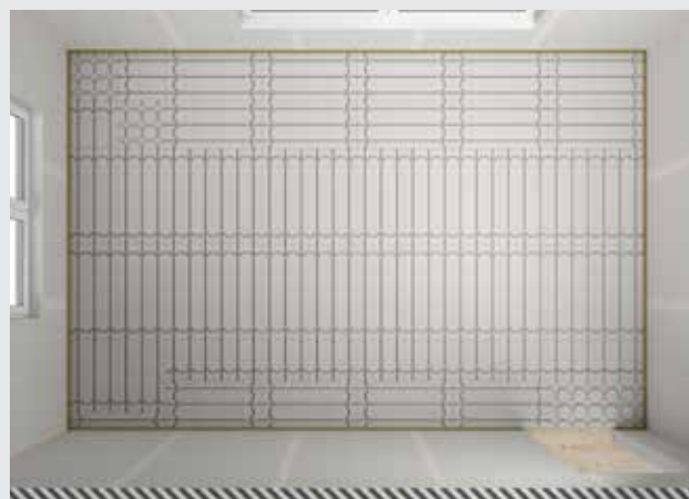
Instalační schéma se dvěma topnými okruhy
