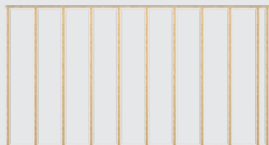
Osová vzdálenost spodní konstrukce max. 500 mm
