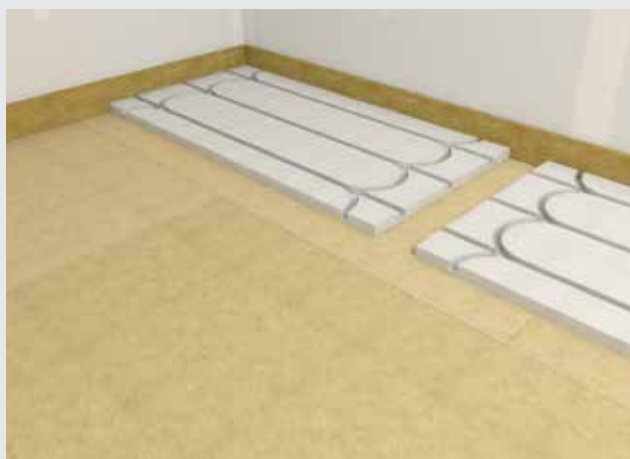
Pokládka prvků fermacell ® Therm25 TM (varianta 1) volně položených, spojených na tupo v křížové vazbě
