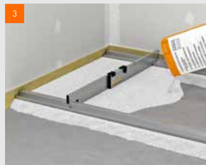
Aplikace vyrovnávacího podsypu
