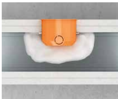
Montážní stěna bez izolace pro protipožární ochranu – zásuvky, krabice vypínačů a rozdělovačů atd. musí být uvnitř dutiny stěny kompletně zabudovány za pomoci spárovacího tmelu fermacell™ o minimální tloušťce 20 mm.
