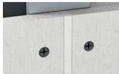
Tmelená spára fermacell™ – šířka spáry: \frac{1}{2} \times tloušťka desky + max. 3 mm
