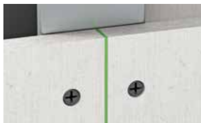
Lepená spára fermacell™ – šířka spáry: \leq 1 mm
